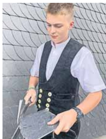
Bearbeitung von Schieferplatten - die Dachdecker Ausbildung hält viele Herausforderungen bereit.
